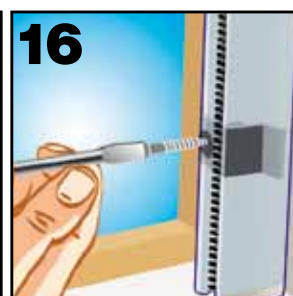
15 Réunir l'ensemble coffre et glissières. 16 Visser les glissières pour une fixation définitive.
