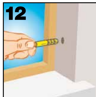
11/12 Percez les glissières et le mur au Ø 5 mm en utilisant le gabarit.
